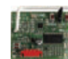
KRIOCN8WS - Moduł sterowania radiowego z gniazdem zaciskowym do zarządzania akcesoriami bezprzewodowymi dla serii produktów wyposażonych w gniazdo RIO.
