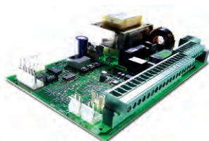
Centrala sterująca słupka JE275 Steruje maks. 3 słupkami typu J275 HA
