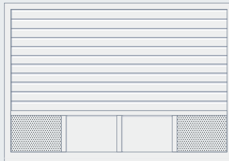
Wzór 499, przykład: wypełnienie z segmentów, blachy perforowanej i blachy aluminiowej
