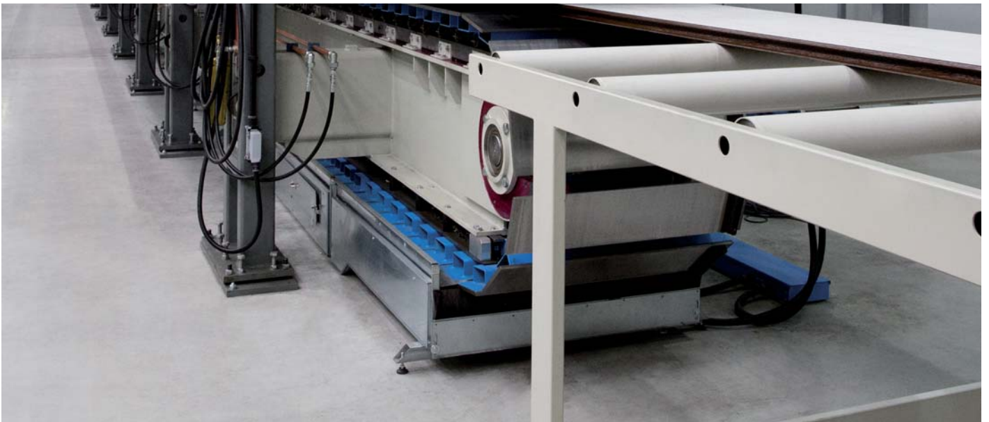
Nowoczesna, sterowana komputerowo linia technologiczna o długości ponad 200 m produkująca w systemie ciągłym panele do bram segmentowych - na zdjęciu etap kształtowania panela.
