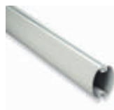
XBA5 ramię aluminiowe, owalne, 69x92x5150 mm
